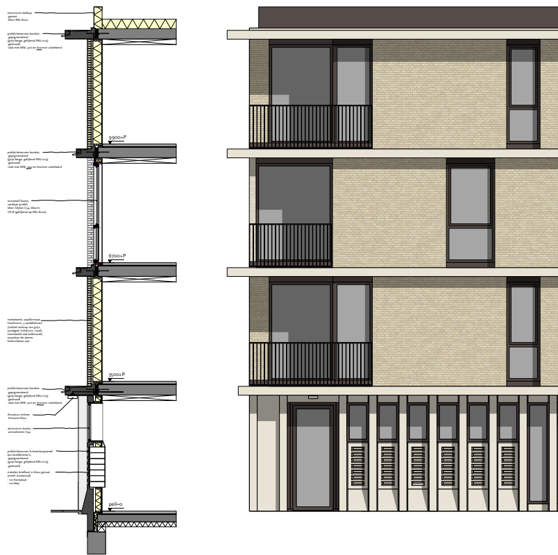
Gevel details en doorsnede
